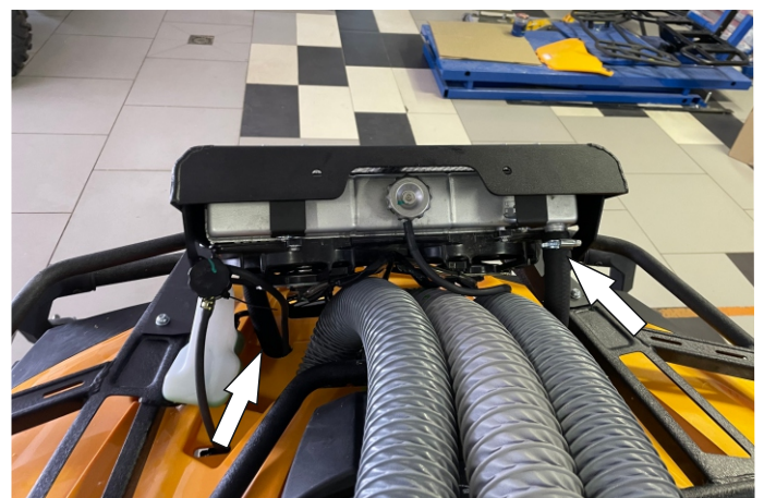
Закрепить корпус радиатора на багажник. Установить шланги на радиатор и закрепить
