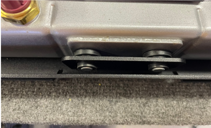
Установить радиатора в корпус выноса.
