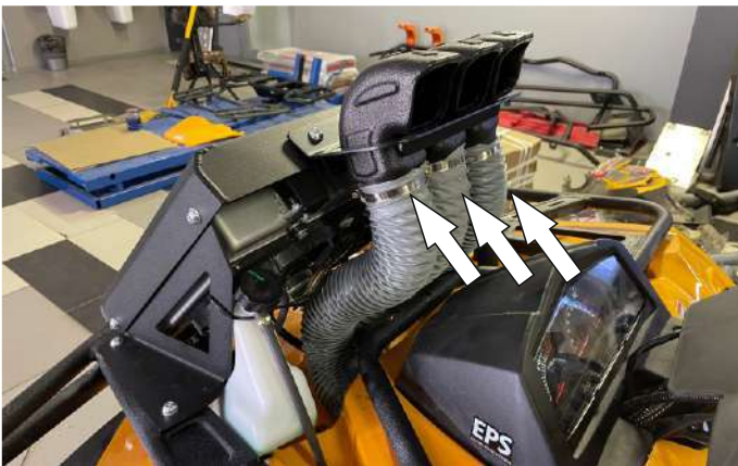
Установить крышки шноркелей на планку. Отрезать гофры по длине (по месту). Закрепить гофры. Установить расширительный бачок
