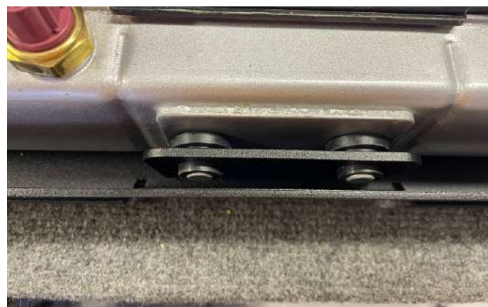
Установить радиатора в корпус выноса.
