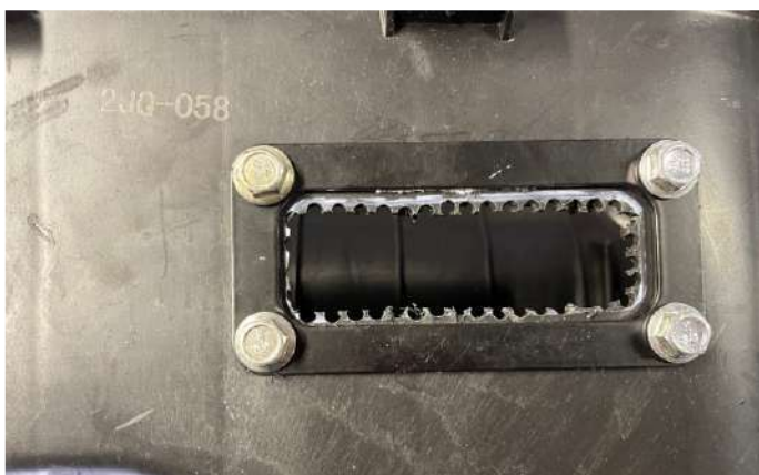
Скруглить стороны прорези режущим инструментом
