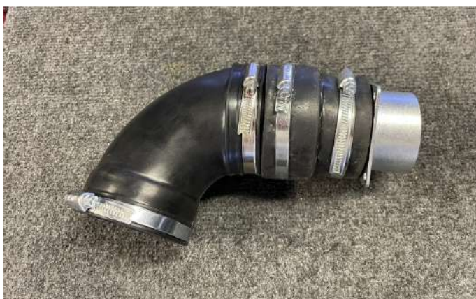
На собранное соединение, установить гофру на стальной соединитель и установить на гофру термоусадочную трубка длиной 1000мм
