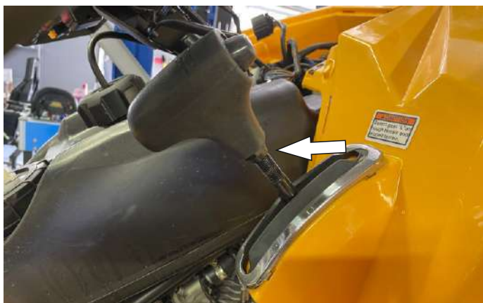
Удерживая гайку ключом. Открутить ручку переключения против часовой стрелки.
