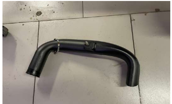
Снять штатный патрубок заднего корпуса вариатора
