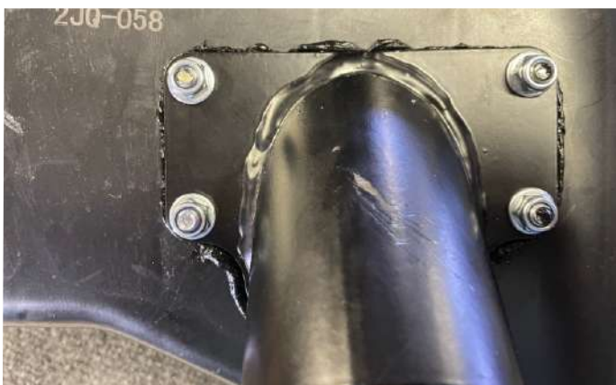
Установить переходник на внешнюю стороны корпуса и пластину на внутреннюю сторону . Снять переходник.
