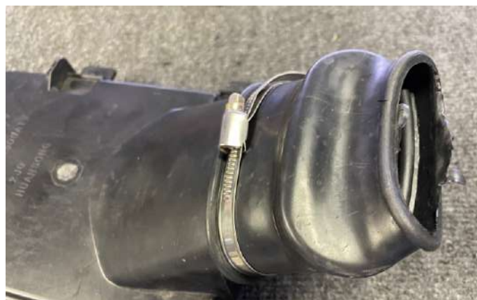
Установить резиновую манжету на крышку воздушного фильтра и притянуть хомутами. Установить крышку на место.
