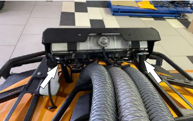
Установить багажную платформу. Закрепить корпус выноса радиатора на багажник. Установить шланги из набора на радиатор и закрепить
