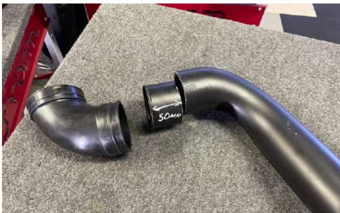
Сделать распил по линии. Расстояние от края до линии 50мм.
