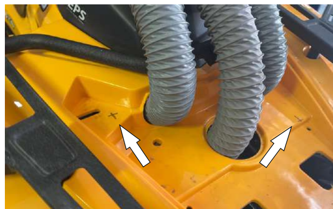
Разметить центры отверстия для шлангов системы охлаждения в выносе радиатора.
