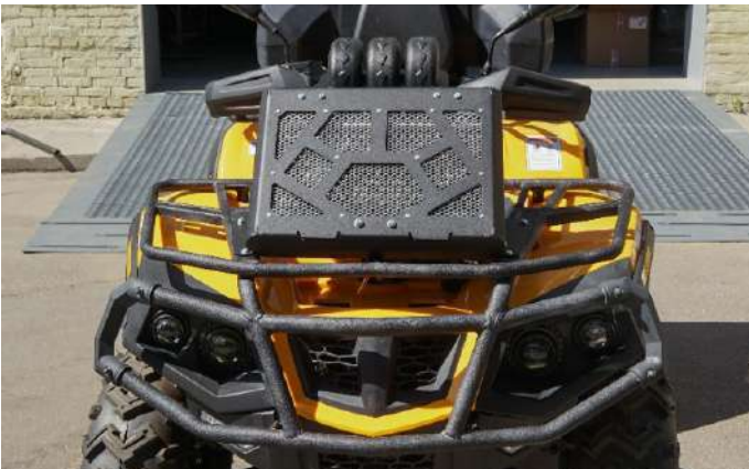
Установить крышки шноркелей на планку. Отрезать гофры по длине (по месту). Закрепить гофры. Установить расширительный бачок
