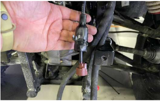
Разъем на датчик температуры радиатора требует удлинения провода
