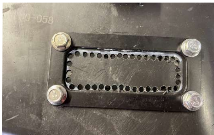
Любым из типов инструментов проделать прорезь в корпусе воздушного фильтра .
