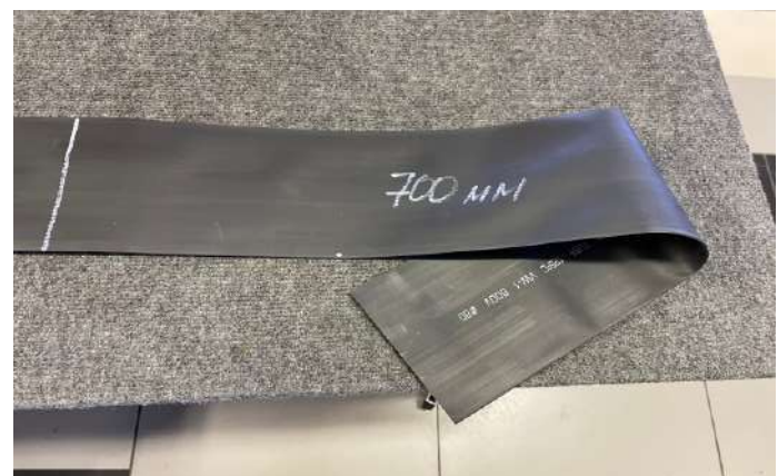
Часть термоусадочной трубки, длиной 700мм, установить на гофру с корпуса воздушного фильтра
