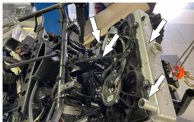
Снять патрубки с радиатора. Разъединить разъемы Вентиляторов и датчика температуры. Снять радиатор с вентиляторами в сборе.
