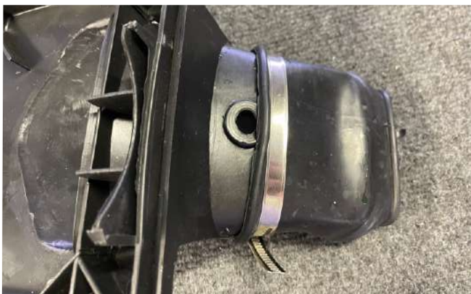
Не закрывать отверстие для вентиляции картерных газов.
