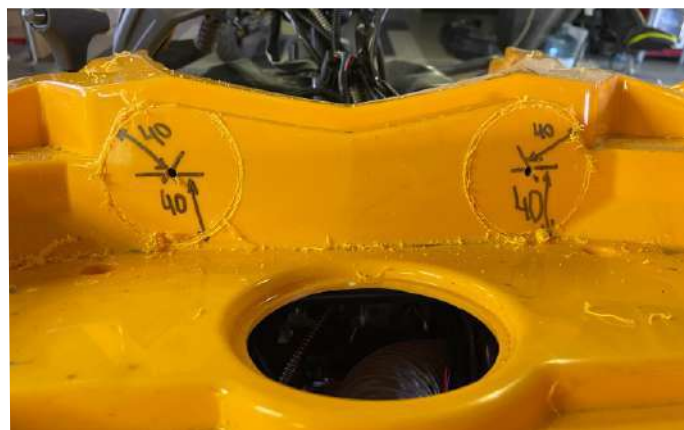
Диаметр потверстий 70-80мм
