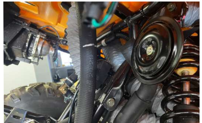
На шланге сделать метку положения края штатного патрубка. Отрезать по метке.
