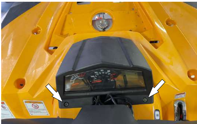
Открутить болты крепления панели приборов. Снять панель приборов.
