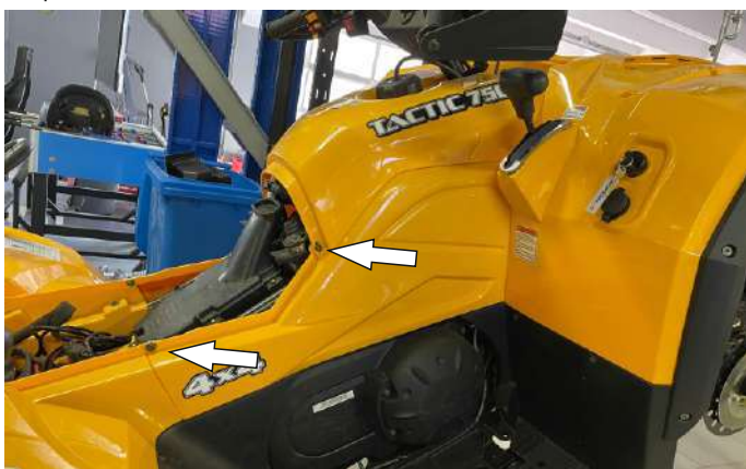
Открутить болты крепления облицовка топливного бака и правой боковой панели.
