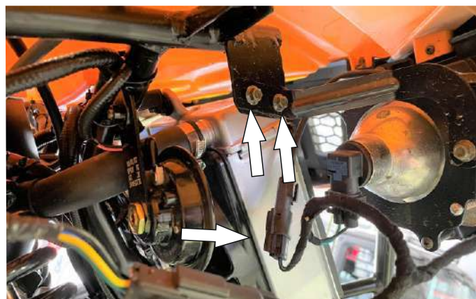
Разъединить разъемы правых передних фар. Открутить болты крепления фар от рамы
