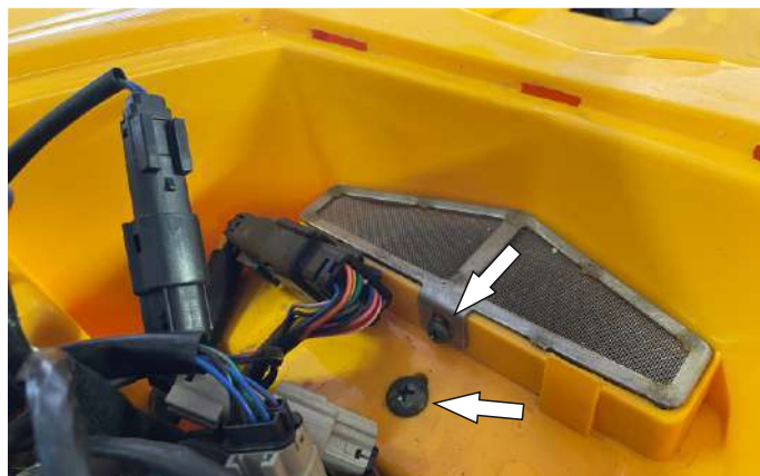
Открутить болты крепления сетки входа шноркеля корпуса вариатора. Открутить болт крепления переднего пластика
