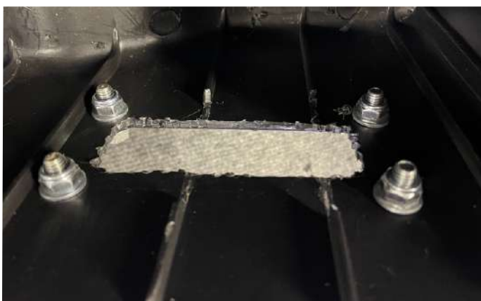
Снять пластину и обезжирить обе стороны прилегания переходника
