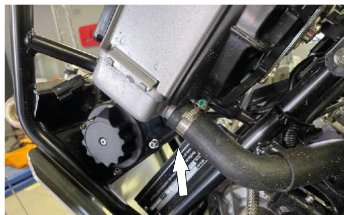
Снять хомут с нижнего патрубка радиатора. Слить антифриз
