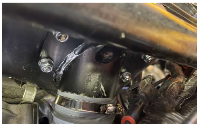
Установить корпус воздушного фильтра на место. Установить гофру и з набора и затянуть хомутом.
