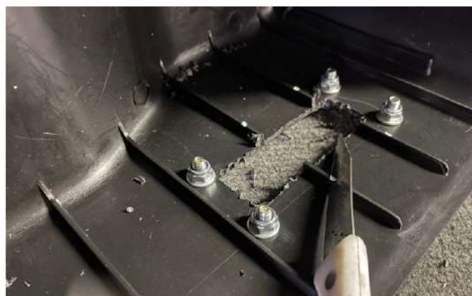
Режущим инструментом , удалить ребра жесткости с внутренней части корпуса воздушного фильтра. для установки пластины
