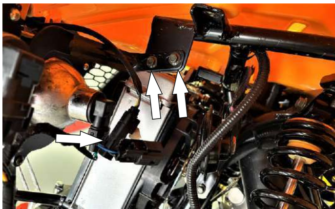
Разъединить разъемы левых передних фар. Открутить болты крепления фар от рамы
