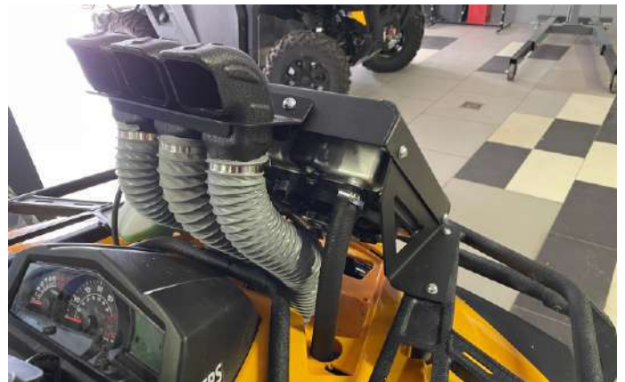
Заправить систему охлаждения антифризом. Завести. Прогреть. Убедиться в отсутствие течи. Дождаться двукратного включения вентилятора
