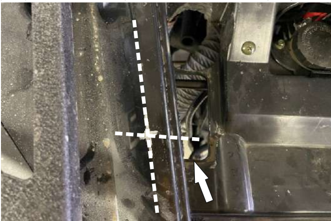
Разметить точку для сверления отверстия. Прямая ребра пластика и кромки в нише. Как на рисунке.
