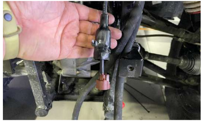
Разъем на датчик температуры радиатора требует удлинения провода
