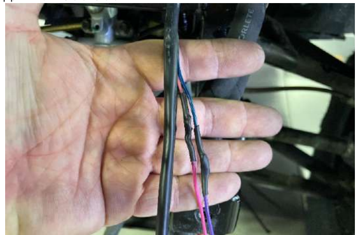
Упаковать провод в общую изоляцию и/или гофру . Проложить провод к радиатору и подключить
