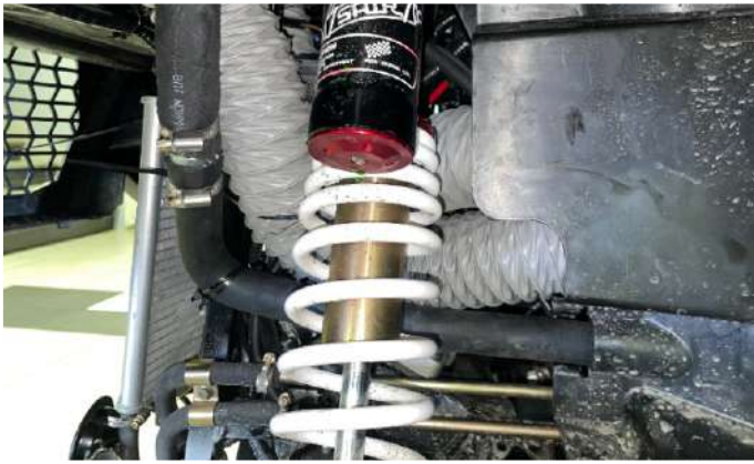
Соединить штатный патрубок и остатка патрубка из комплекта через соединитель.
