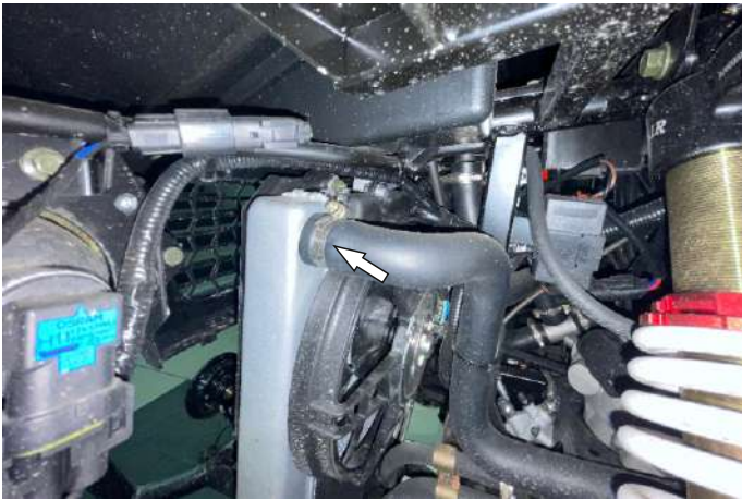
Снять верхний шланг радиатора
