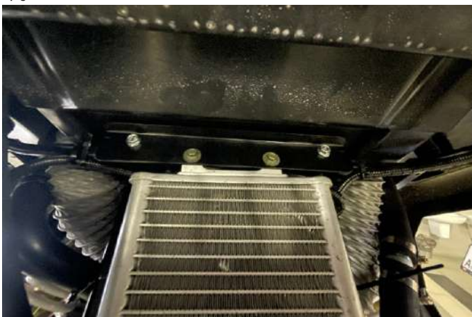
Установить кронштейн на масляный радиатор установить на штатное место основного радиатора
