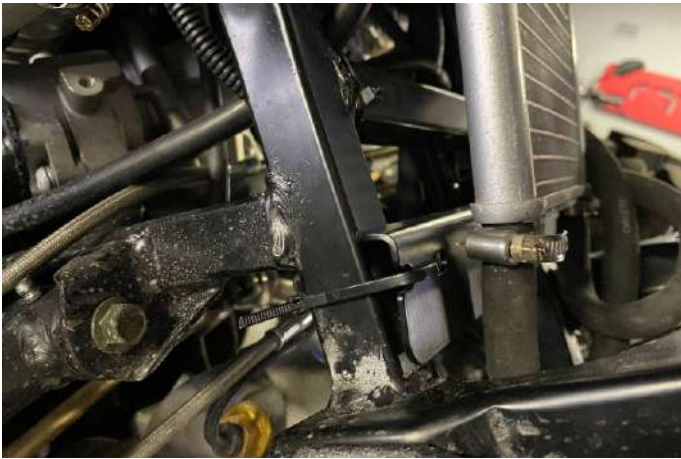
Притянуть нижний кронштейн масляного радиатора пластиковыми хомута к раме
