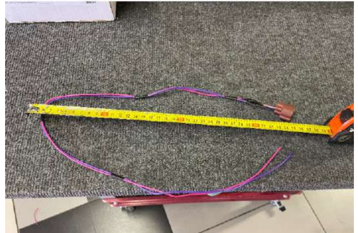
Соединить разъем с проводом 2x0,5кв.мм. длиной 800-900мм
